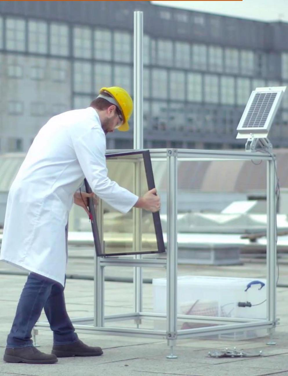
Glass to Power **IPTG (Insulating Photovoltaic Transparent Glass)** è in grado di produrre energia elettrica attraverso le radiazioni solari. È Un prodotto innovativo che migliora gli standard progettuali degli edifici in vetro strutturale e di tutti quegli edifici in cui l'elemento in vetro produce attivamente energia.
